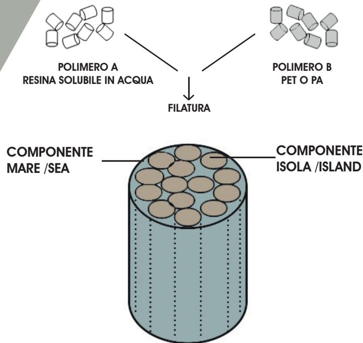
Quando due polimeri vengono co-estrusi per creare un'unica fibra, questo stato di dispersione nella sezione trasversale della fibra, viene indicato come "isola", mentre la matrice è equivalente al "mare". Quando il componente "mare" viene eliminato attraverso processi specifici, è possibile ottenere un gruppo di microfibre di finessa.
